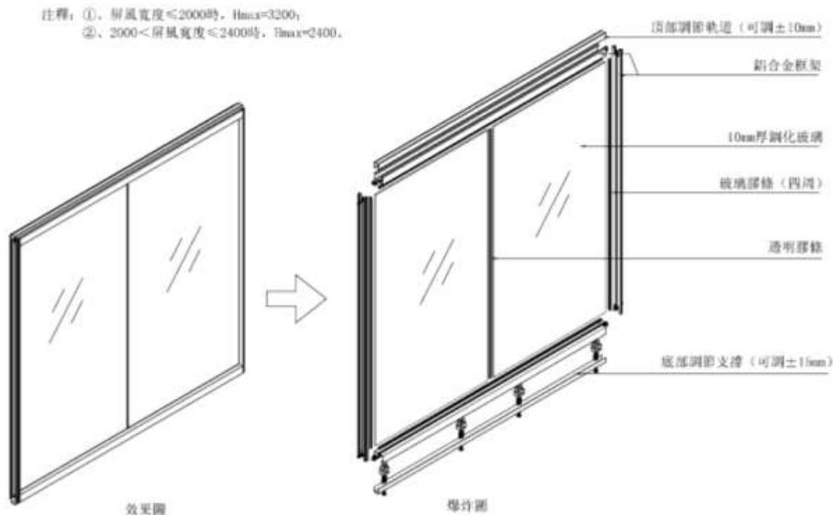
玻璃W（寬度）： $1200\text{mm} < W \leq 2000\text{mm}$  時， $H_{max}$ （最大高度）= 3200mm
